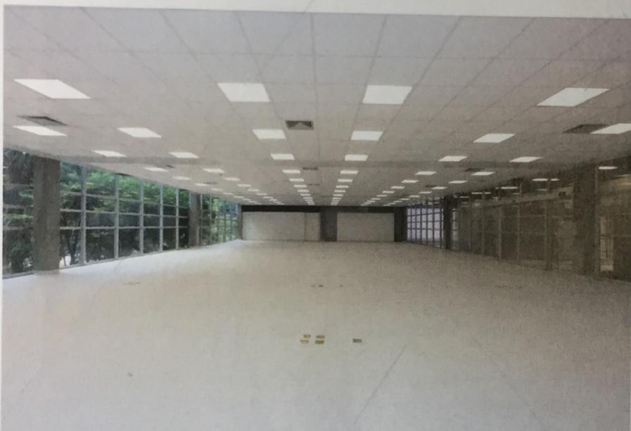
Solução de cobertura em um único vão de treliças metálicas permitiu ocupação do último pavimento do bloco de laboratório sem nenhum pilar
